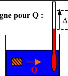
remarque : la chaleur Q va naturellement (on dit "spontanément" en thermodynamique) du corps le plus chaud au corps le plus froid : le morceau est initialement à une température > température de l'eau.
