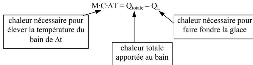
On peut dire que la chaleur latente traduit l'inertie, la "récalcitrance" du corps à modifier son état de phase : pour élever sa température il faut d'abord s'assurer qu'il ne va pas changer de phase, s'il change de phase pendant l'augmentation de température alors une énergie supplémentaire doit être fournie pour "franchir" le cap : le changement de phase nécessite un apport d'énergie (ou un retrait selon le sens du changement de phase).
