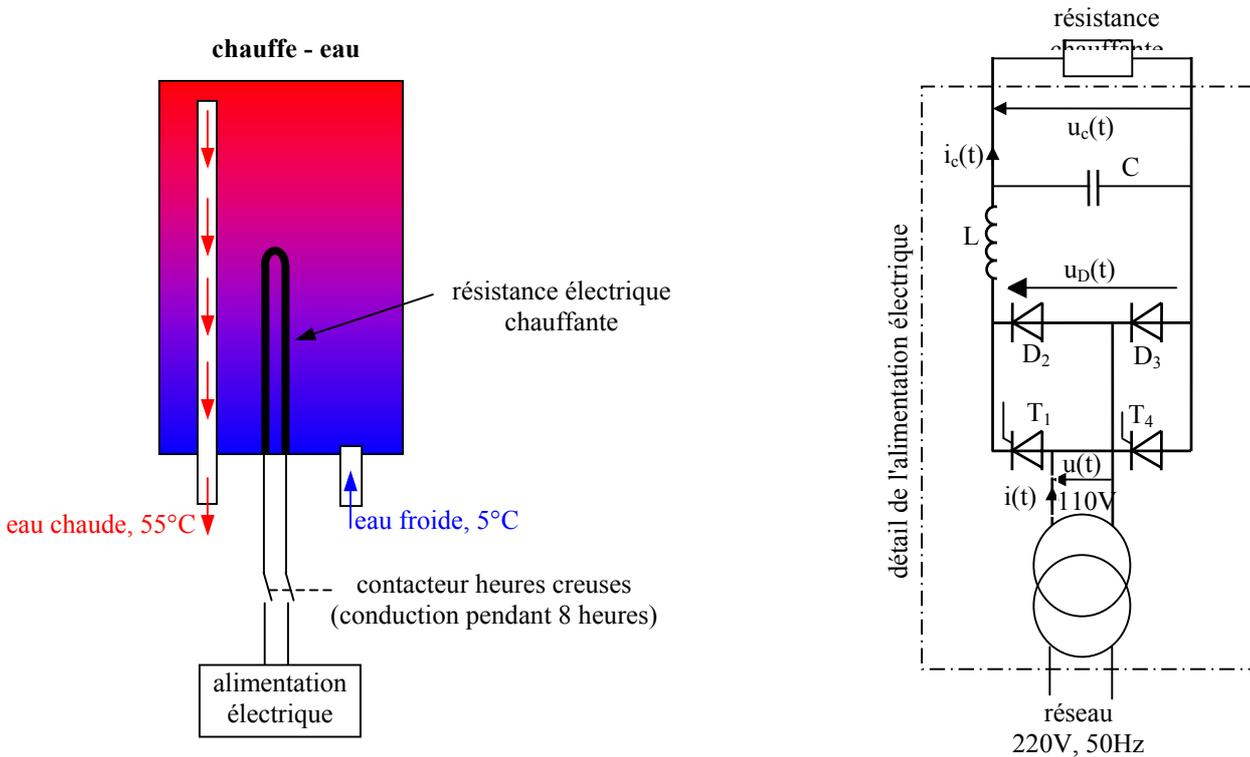
On souhaite que l'eau chaude sorte à une température de 55 °C du chauffe - eau, alors qu'elle y entre et y est stockée à 5°C. On donne la chaleur massique de l'eau :  $C \approx 4,18 \text{ kJ.kg}^{-1}.\text{K}^{-1}$ .
