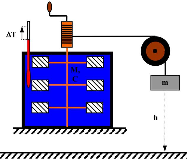
$$\left. \begin{array}{l} W = mgh \quad [J] \\ Q = M \cdot C \cdot \Delta T \quad [\text{cal}] \end{array} \right\} \text{ même } \Delta T \Rightarrow W \text{ et } Q \text{ ont les mêmes effets}$$
